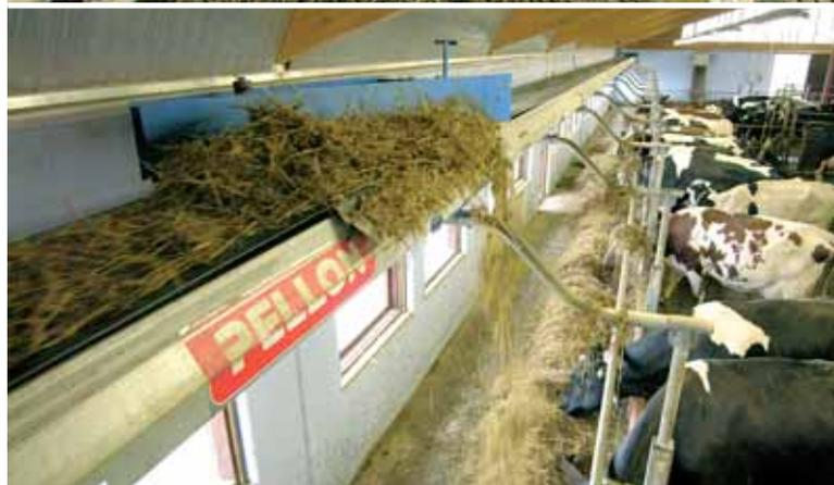
Mit dem Pellon Bandfütterungssystem in Verbindung mit dem zugehörigen Graphics-Management-System können individuell abgestimmte Futtermengen an einzelne Tiere oder Gruppen ausgeteilt werden.
