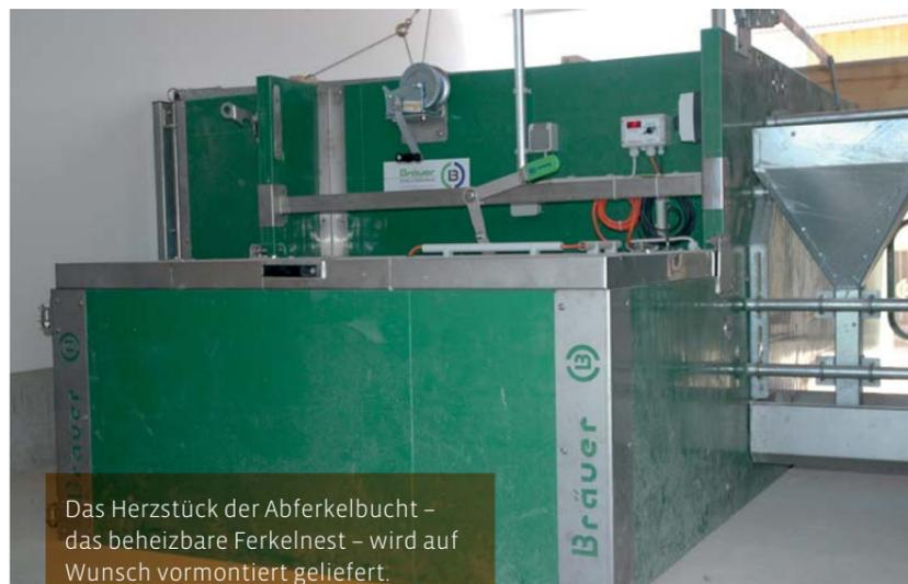
Das Herzstück der Abferkelbucht – das beheizbare Ferkelnest – wird auf Wunsch vormontiert geliefert. Der absperrbare Sauenfressplatz (für den Personenschutz) wird mit einem Futtermitteltrichter aus- gestattet, damit die Muttersau über den Tag verteilt mit Futter versorgt ist.
