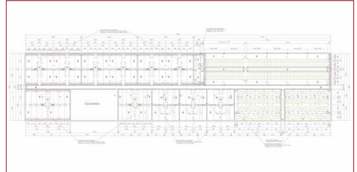
geschlossenes Schweinestallsystem mit Unterflurzuluft für 140 Muttersauen mit Ferkelaufzucht und Endmast
