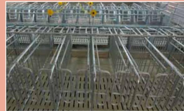
mit Einzel- und Zentralverriegelung, Hintertüren können separat links oder rechts geöffnet werden, einfaches Arbeiten wird auch während der Besamung gewährleistet
