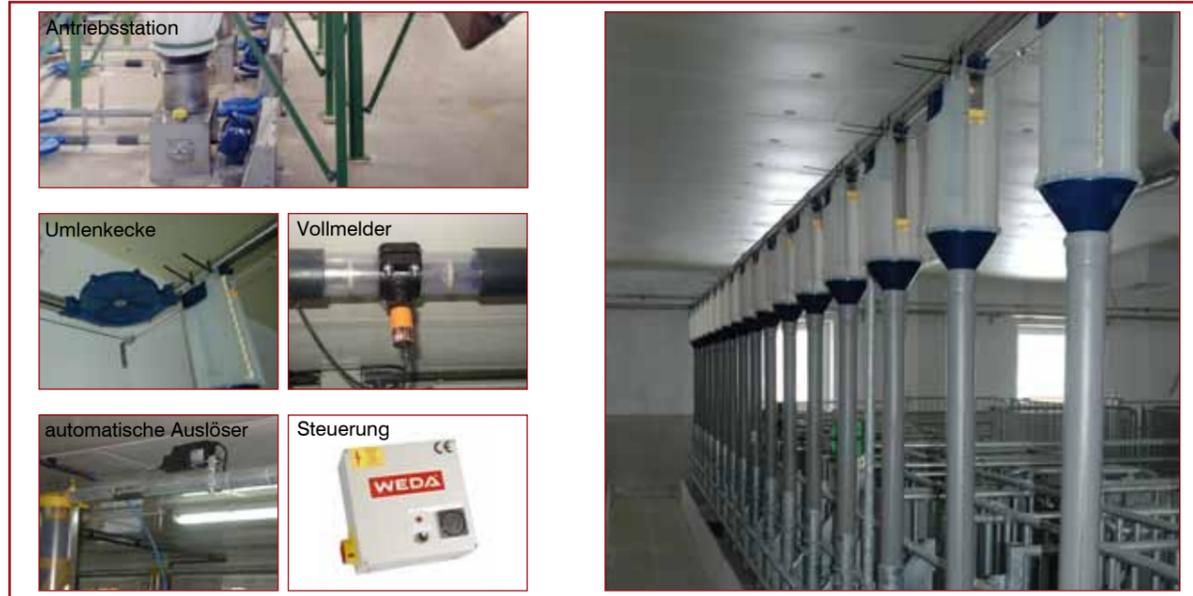
Bräuer Trockenfütterungsdosierer mit separater Öffnung zum Reinigen
