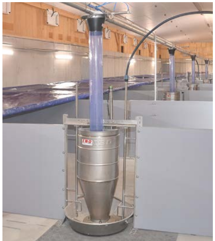
SENSORÜBERWACHTER FUTTERAUTOMAT MIT VOLLAUTOMATISCHEM FUTTERVENTIL
