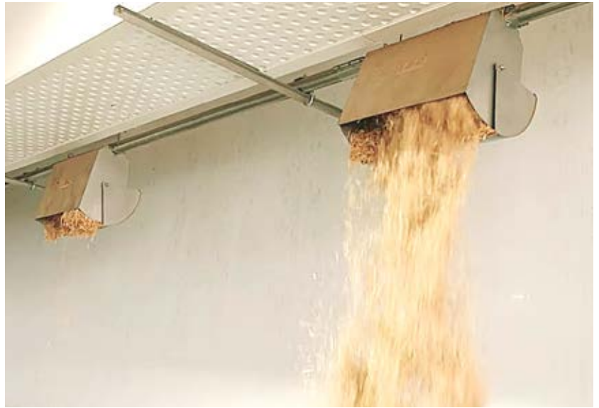
Einstreuen für die Flächenstreu in Stroh Vorratsbehälter, bis zu 50 Liter Stroh je Behälter
