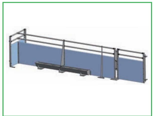
Doppelnirotrog mit Trennwandaussteifung und Ablassöffnung
